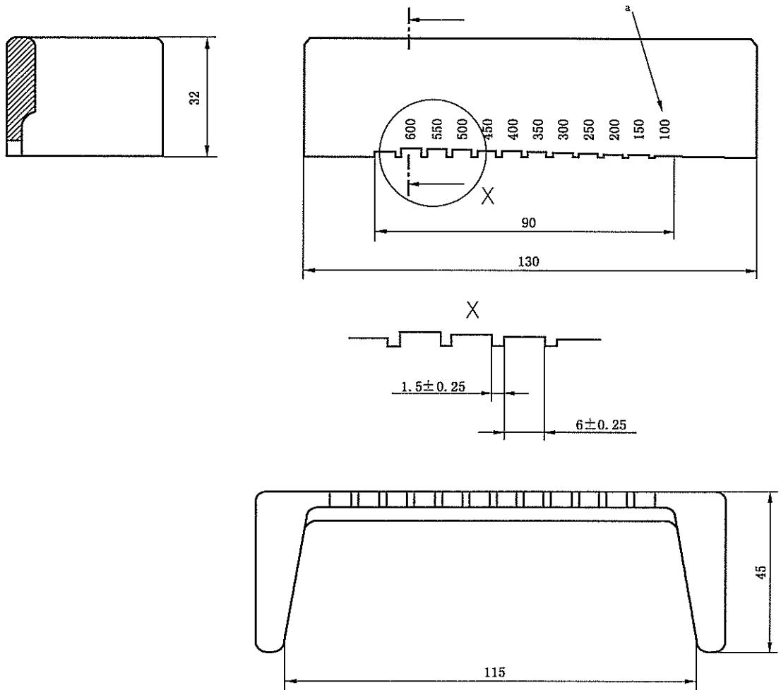
\* 典型凹槽深度测量值( $\mu\text{m}$ )。
